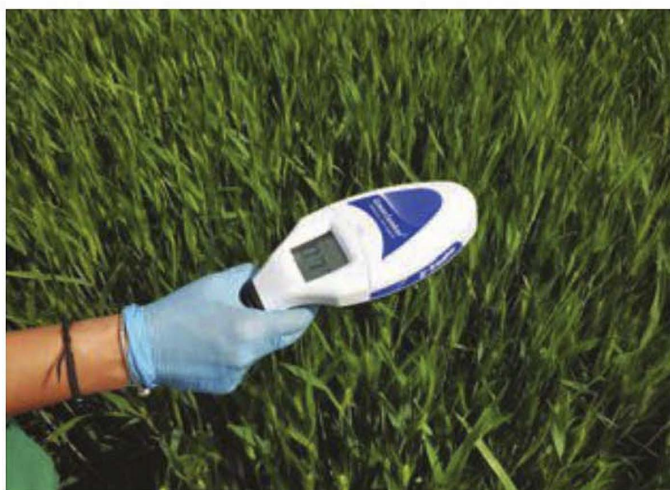
Foto 1. Medidas del índice de vegetación de diferencia normalizada (NDVI) Trimble® GreenSeeker®.
